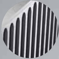
激光雕刻 表面质量达Ra 1.0 μm
